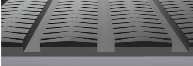
Abb. 21: Planbefestigter Rillenboden mit Profil (© KTBL)
