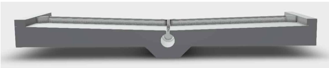
Abb. 19: Planbefestigter Boden mit Quergefälle und Harnsammelrinne (© KTBL)
