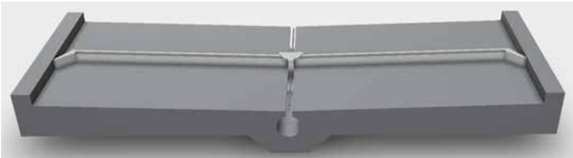
Abb. 20: Planbefestigter Boden mit Quergefälle, Harnrinne und angepasstem Entmistungsschieber (© KTBL)
