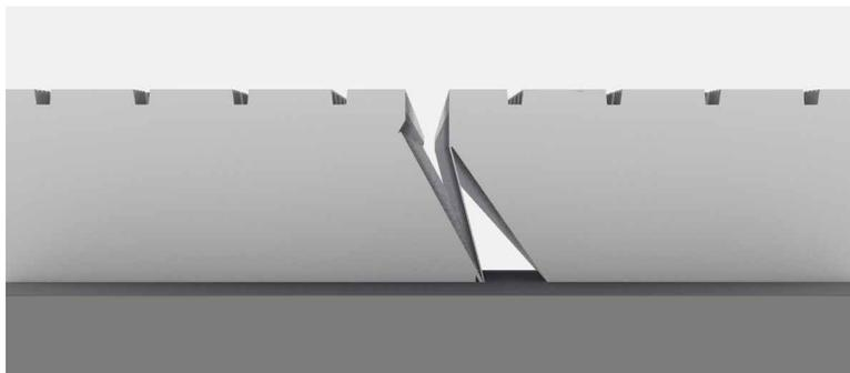
Abb. 11: Bodenelement mit Dichtungsklappe, die den Gasaustausch mit dem Flüssigmistkanal reduziert; seitliche Ansicht im Detail (© KTBL)
