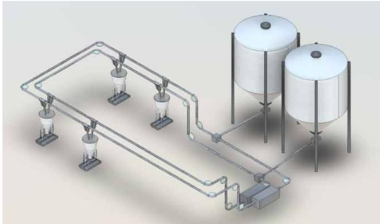
Abb. 24: Grundprinzip einer 2-phasigen Fütterung mit zwei parallel angeordneten Verteilsystemen (© KTBL)
