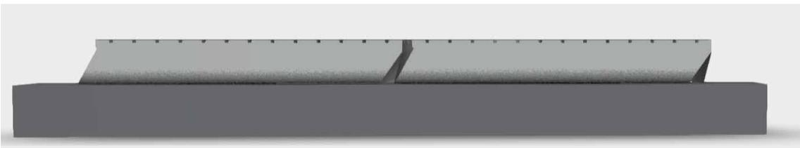
Abb. 10: Perforierter Boden mit Profil und Schlitten in größeren, regelmäßigen Abständen sowie Dichtungsklappen in den Schlitten; Seitenansicht (© KTBL)
