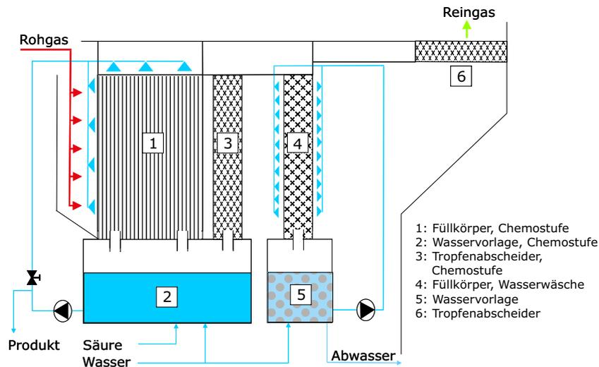
Abb. 3: Prinzip einer zweistufigen Abluftreinigungsanlage (Chemowäsche + Wasserwäsche) (KTBL 2006)
