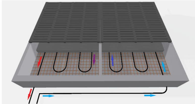
Abb. 26: Güllekühlung mittels im Boden verlegten, auf der Bewehrung aufliegenden Kühlleitungen (© KTBL)
